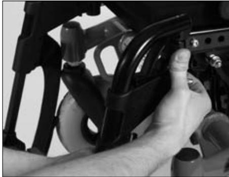
**Abb. 6** Fußstütze entfernen
