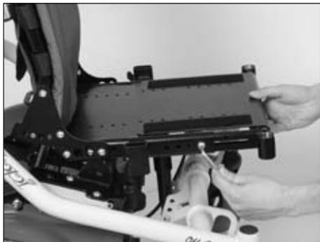
Abb. 25 Fußstützenaufnahme: In Längsrichtung einstellen
