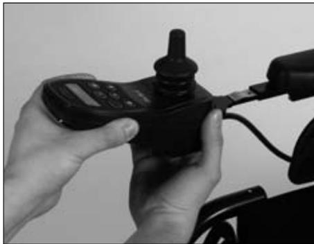
**Abb. 7** Bedienpult entfernen
