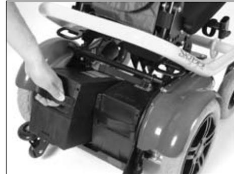
**Abb. 11 Entnahme der Akkupacks**
