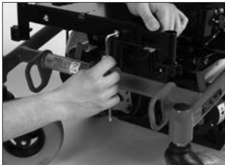
Abb. 26 Fußstützenaufnahme: In Querrichtung einstellen
