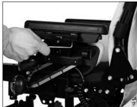
Abb. 19 Armauflagen an Unterarmlänge anpassen
