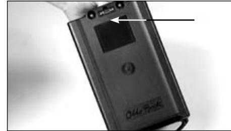
Abb. 44 Akkupack mit Sicherung
