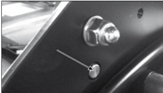
Abb. 14b Verriegelungsbolzen eingerastet
