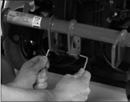
Abb. 16 Innensechskantschrauben lösen
