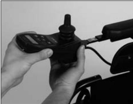
Abb. 20 Herausziehen des Bedienpults
